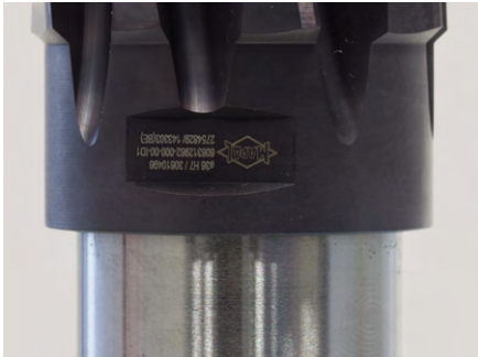
Ergebnis: Der Spalt zwischen Wechselkopf und Wechselkopfhalter ist geschlossen und eine kraft- und formschlüssige Verbind­ung besteht. Der Wechselkopf XR ist jetzt betriebsbereit.
